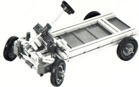
Abb. 2: Funktionsmodell einer Achsschenkellenkung mit Lenkgetriebe (Zahnstangenlenkung).
