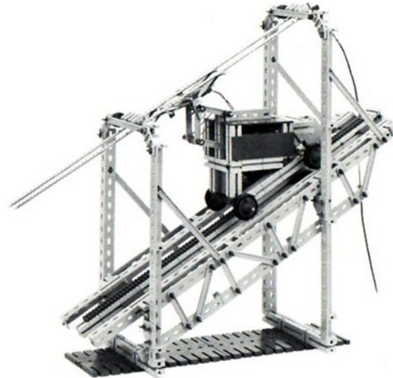
Abb. 24: Modell einer Zahnradbahn. Stromentnahme über Fahrdrähte und Stromabnehmer.
