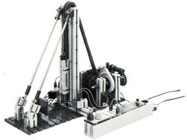
Abb. 14: Modell einer Zugramme zum Eintreiben von Pfählen. Beispiel für die Anwendung einer Lichtschranke als Sicherheitseinrichtung (Absicherung einer Arbeitsbühne).
