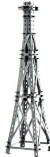
Abb. 20: Modell eines Aussichtsturms mit übereinanderliegenden Diagonalstreben.
