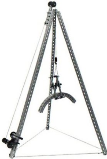
Abb. 23: Modell eines einfachen Hebezeugs. Dreibock mit Seilwinde und Greifer.
