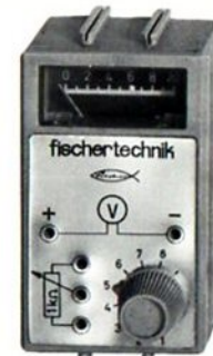
Abb. 27b: Zur Durchführung von Experimenten empfehlen wir unser „fischertechnik“-Voltmeter. Meßbereich: 10 V Gleichspannung.
