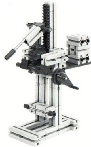
Abb. 4: Funktionsmodell einer Zahnstangenwinde mit Rücklaufperre.
