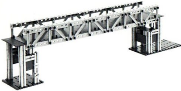
Abb. 17: Modell einer einfachen Fachwerkbrücke (Ober- und Untergurt) mit einem festen und einem Rollen-Auflager.
